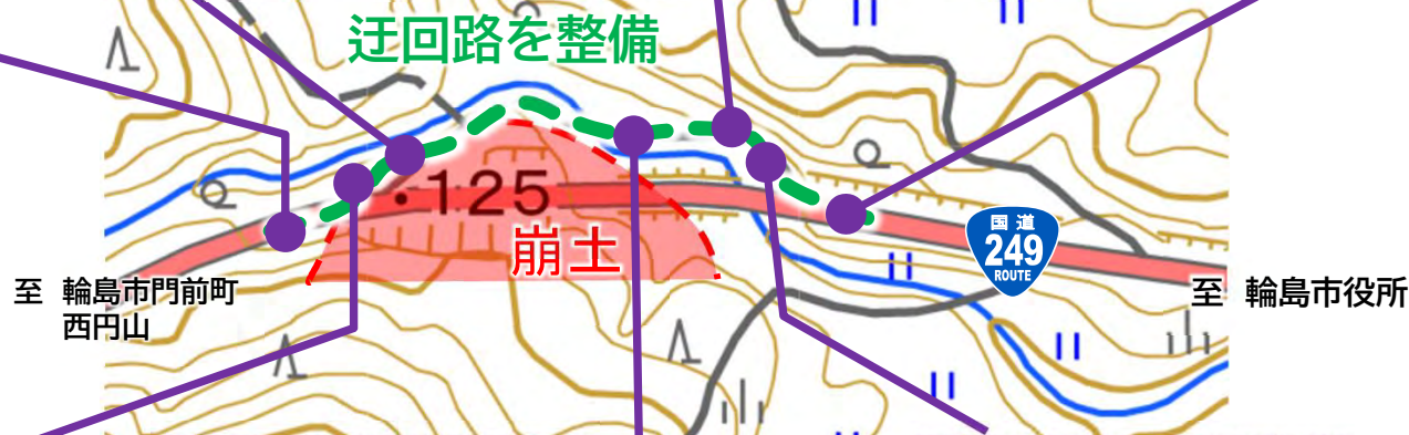
啓開作業状況 (崩落箇所を迂回するルートを整備)
