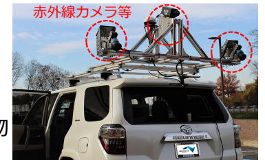
赤外線カメラ等による コンクリート床版の点検
