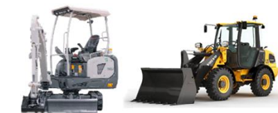
電動油圧ショベル 電動ホイールローダ 低炭素な建設機械の普及を促進 （出典：竹内製作所HP） （出典：VOLVO Construction Equipment Japan HP）
