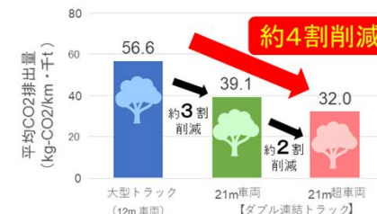
ダブル連結トラックによるCO 2 削減効果 (千ト・km当たりの排出量)
