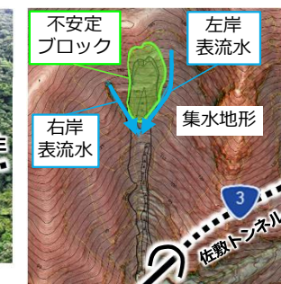
高度化された点検手法の例 レーザープロファイラ調査
