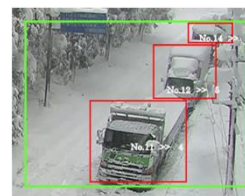
交通障害自動検知システム
