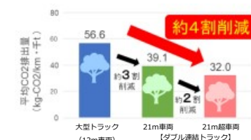
ダブル連結トラックによるCO 2 削減効果 (千t・km当たりの排出量)
