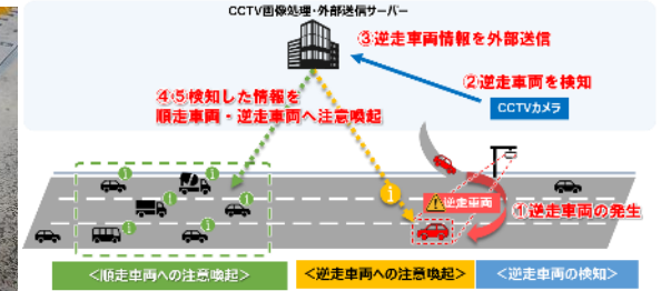
道路管理用カメラによる 逆走検知・警告技術の概要
