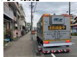
路面下空洞調査
