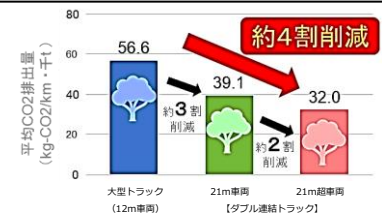
ダブル連結トラックによるCO 2 削減効果 (トン・km当たりの排出量)
