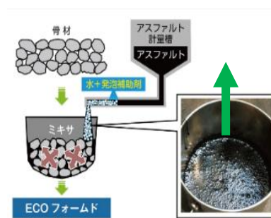
アスファルトの中温化技術
