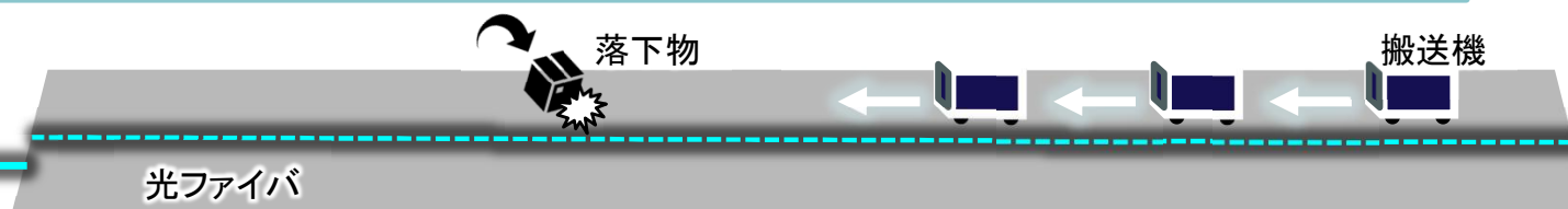
光ファイバによる落下物検知のシステム構成と処理フロー
