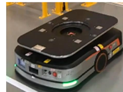
AGV (最大積載量:600kg)
