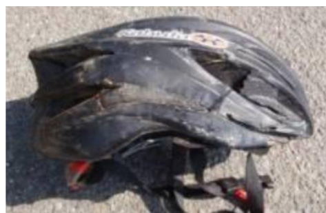
自転車は前後輪とも外れハンドルは変形、ヘルメットは右側頭部が破損
