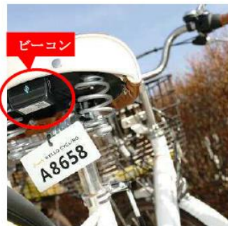
図 Bluetoothビーコン取付状況
