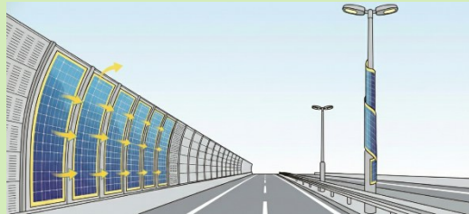
遮音壁への設置イメージ
