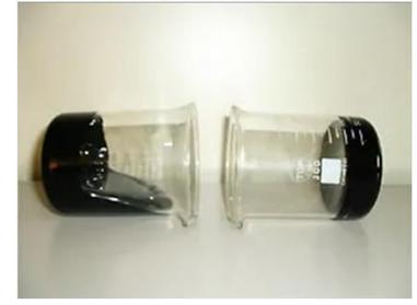
写真②-アスファルトが流れる様子
