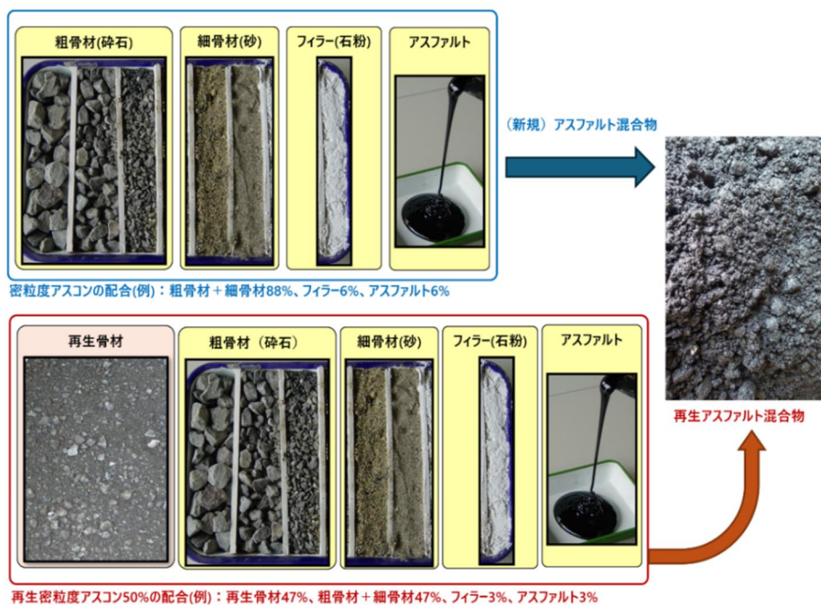
図Ⅱ－２：新規アスファルト合材と再生アスファルト合材の違い
