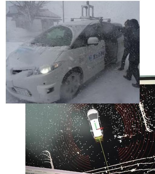
〈降雪をLiDARで検知したことによる走行性能の低下が発生〉
