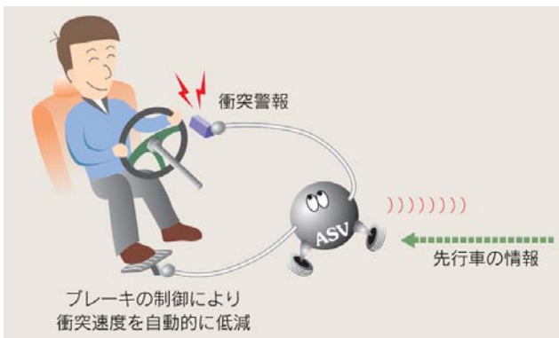
衝突被害軽減ブレーキ装置の働き (イメージ)
