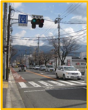
写真Ⅱ-6 道路標識「専用通行帯(327の4)」と道路標示「専用通行帯(109の6)」を設置した事例
