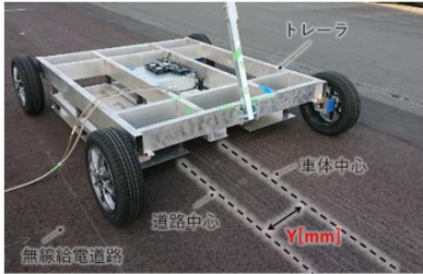
図2-4 受電装置を搭載したトレーラ
