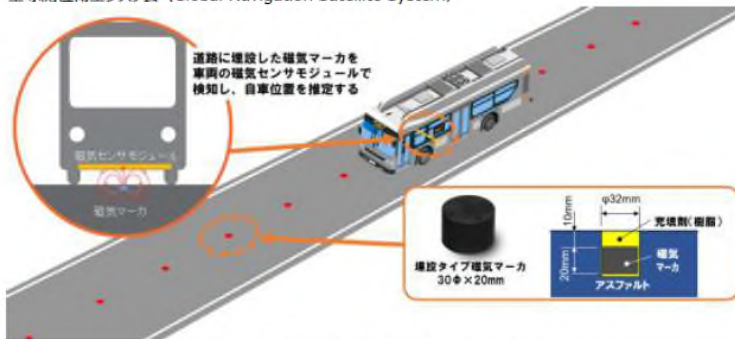
磁気を用いて自車位置を推定する磁気マーカシステム
