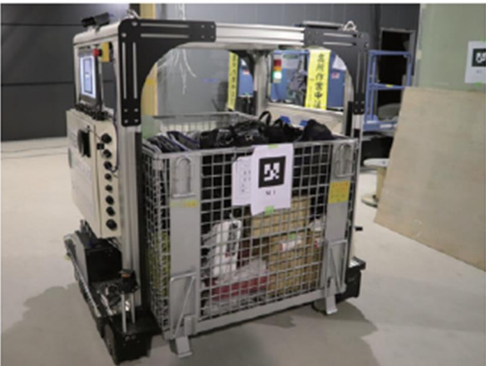
写真-6 AGVによるかご台車の搬送状況
