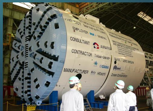
ボスボラス鉄道トンネル(掘削径 7.93m )
