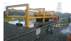
▲輪荷重試験器による耐久性能試験の状況
