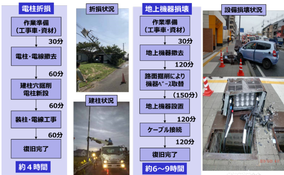
＜電柱と地上機器における設備単体での復旧時間（イメージ）＞
