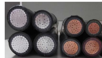
CEQ400mm<sup>2</sup> (アルミ導体)    CVQ250mm<sup>2</sup> (銅導体)
