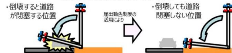
【道路の閉塞を防止する仕組み(イメージ)】
