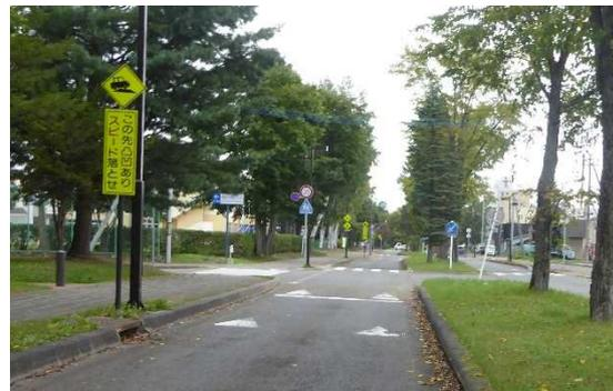
図6-24 ハンプ設置事例（積雪地）
