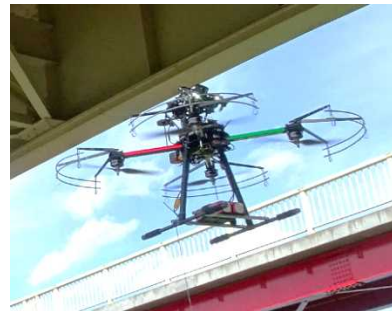
▲橋梁の損傷写真を撮影する技術
