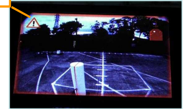
物体検知・警告技術 検知状況
