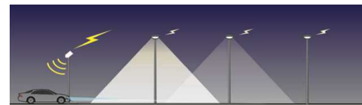
センシング技術により車両等を検知したときのみ点灯する照明
