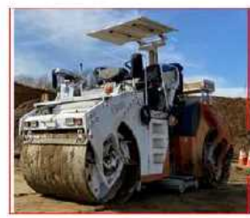
転輪型RI密度水分計搭載自動化振動ローラ
