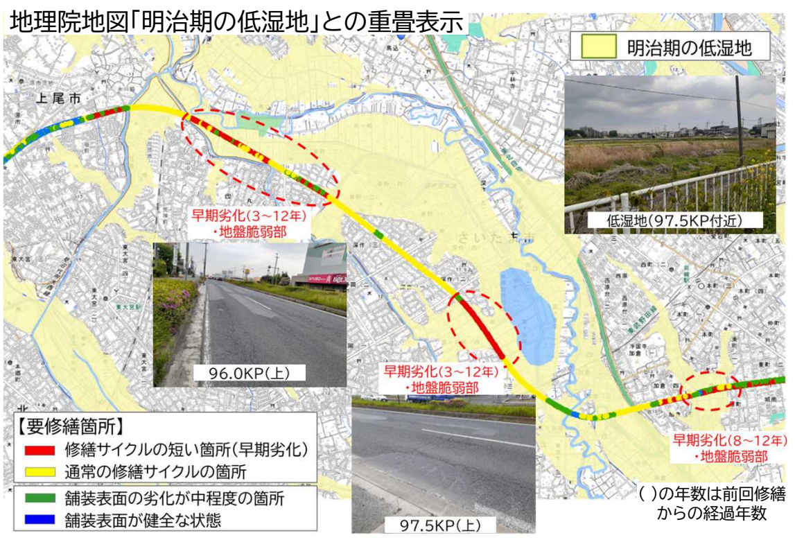
早期劣化と土地の成り立ちの関係性の事例 (国道16号 大宮～岩槻間)
