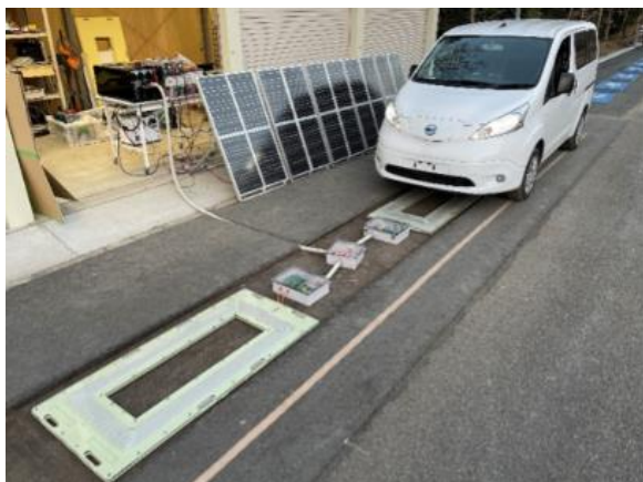
コイル・電極の舗装埋設による給電試験の様子 (左:東京理科大学居村研究室、右:大成建設)
