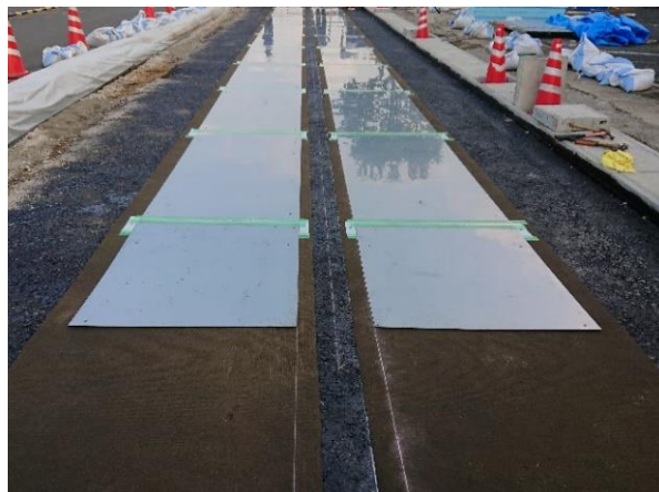
コイル・電極の舗装埋設による給電試験の様子 (左:東京理科大学居村研究室、右:大成建設)
