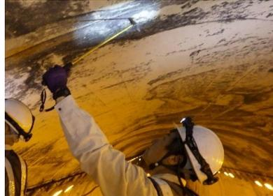
打音検査により、うき等による打音異常の有無を確認
