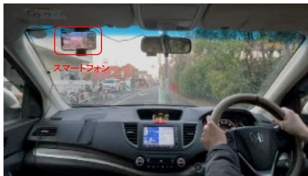
車両に車載簡易装置(スマートフォン)を取り付けて、走行しながら車両前方画像と加速度を取得し、ポットホールの有無を点検。計測データはクラウドサーバ上でAI解析され、インターネット上で即日中に点検結果を確認できる。
