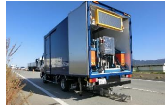
静止車両によるたわみ計測
