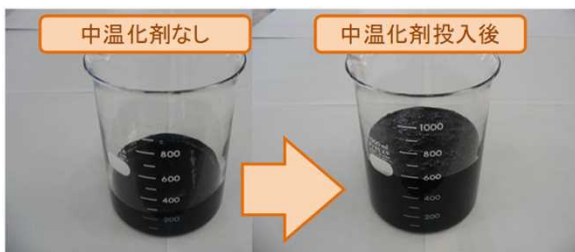
添加剤(中温化剤)の例 ～泡を発生させ骨材へのコーティングが滑らかに
