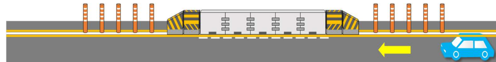
【センターブロック】
