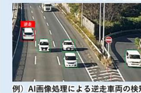
例) AI画像処理による逆走車両の検知
