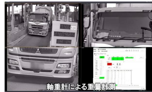
軸重計による重量計測
