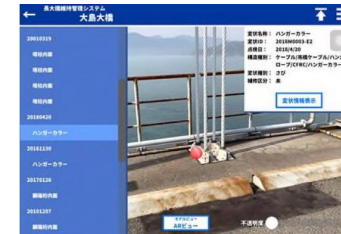
BIM/CIMモデルとMR技術を活用した長大橋点検支援ツール(開発中)
