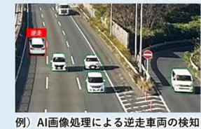
例) AI画像処理による逆走車両の検知
