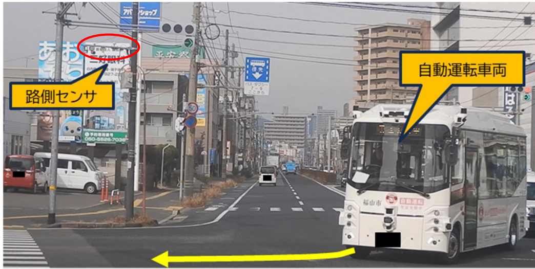
情報提供なし(Without) 大型車の死角を検知不可能
