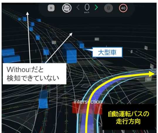
情報提供なし(Without) 大型車の死角を検知不可能
