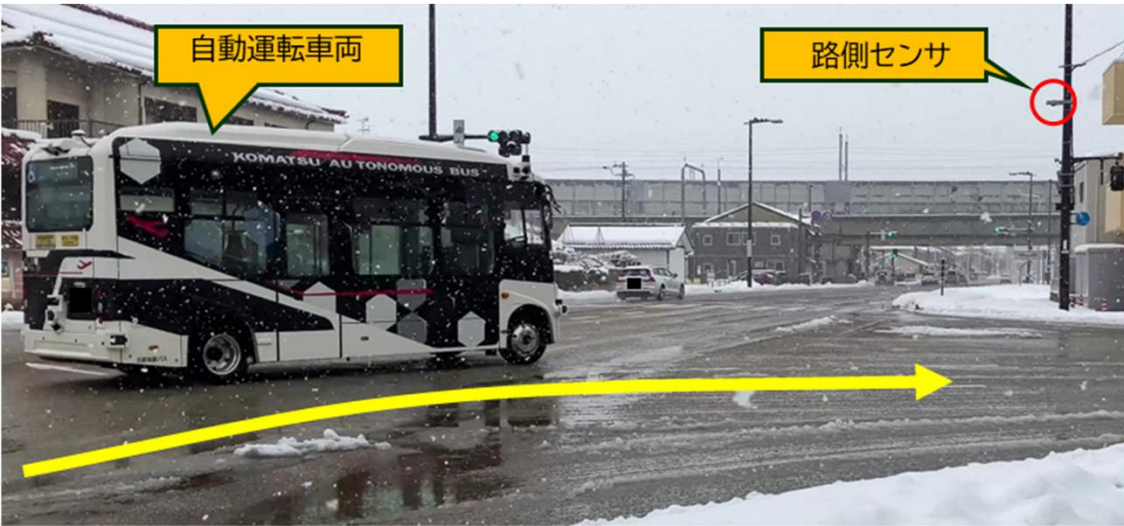
情報提供なし(Without) 遠方の対向車が検知不可能
