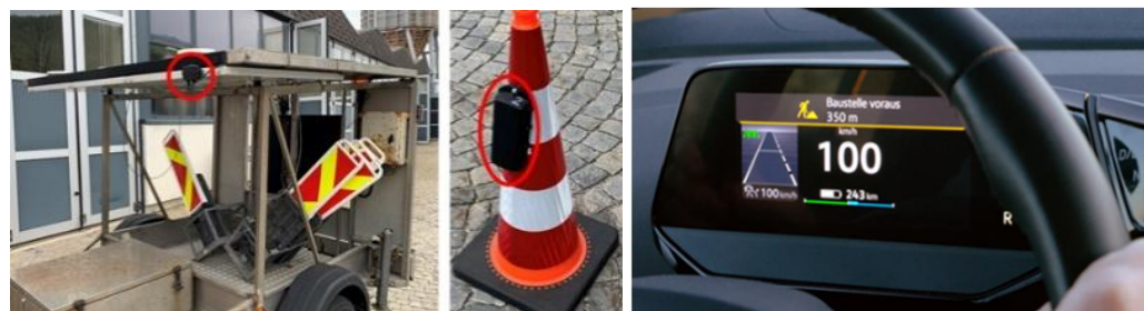
GNSS付トレーラー、コーン(左) 車内での工事規制位置表示(右)
