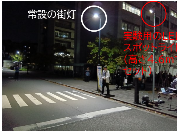
LEDスポットライトの設置状況
