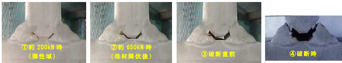
ケース 8-1 R (溶接部破断)
