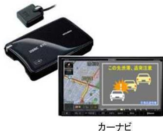
ETC2.0の双方向での情報交換技術により、逆走を検知し、ドライバーに情報提供を行うことができる。(特定の方位や位置情報を検知した際に、逆走と判断する。)
