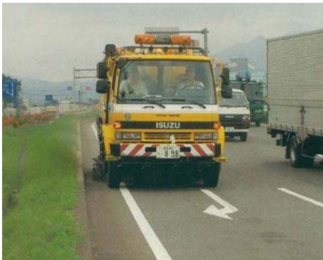
写真 6.1.1 道路のポイント清掃
