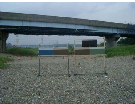
写真 5.12.1 橋梁の色彩検討の様子。大型色見本を現地に持ち込み、周辺景観との関係を確認しながら色彩を最終決定することが最も確実な検討手法である。
