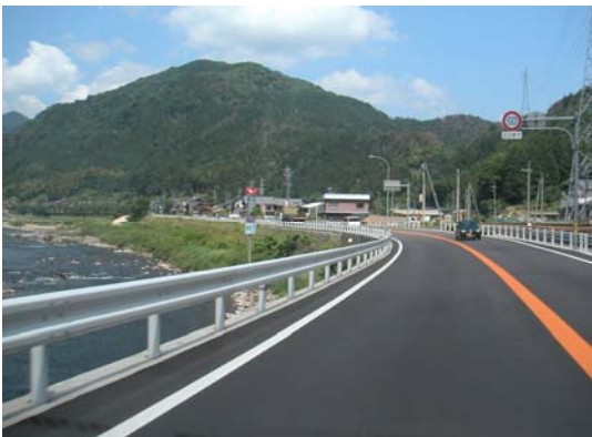
■外部への眺望を阻害している透過性の低い防護柵の例
