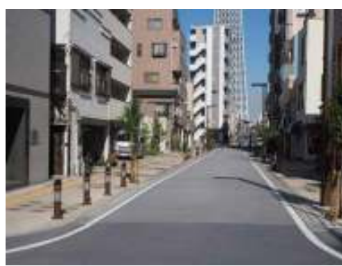
■ シンプルな形状のボラードを歩車道境界に設置している例 沿道出入口により防護柵が断続的になる場合はボラードも有効な選択肢の一つである
