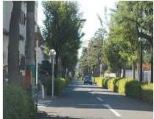
■ 支柱とフードに白色を採用した例 白色の支柱を採用したことで、唐突な印象 を軽減させながら道路反射鏡の視認性を確保している
