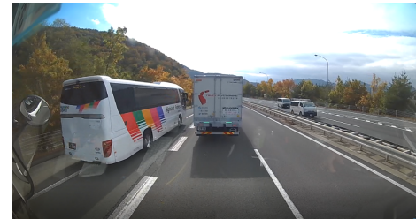
▲合流する大型車(バス)に対し、隊列トラックが本線側から接近したため、バスやトラック(一般車両)が合流できず停車。
