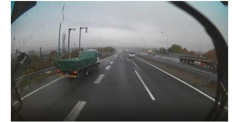
▲合流する大型車(バス)に対し、隊列トラックが本線側から接近したため、バスやトラック(一般車両)が合流できず停車。
