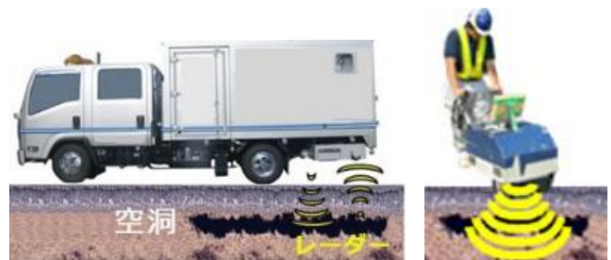
路面下空洞調査
