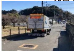
（空洞探査車による調査）
