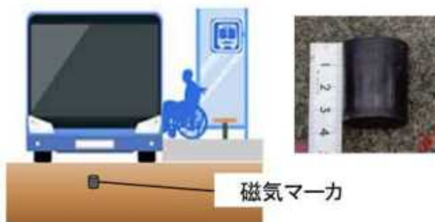
図 2-3-1 磁気マーカを活用した自車位置補正による運行の補助
