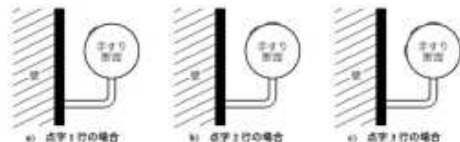
図 手すりの点字表示例
