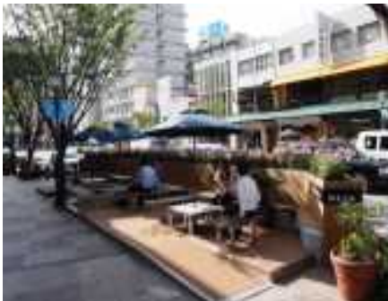
写真 2-1-18 パークレットによって歩行空間との段差を設けることによる誤進入の防止 (兵庫県神戸市)
