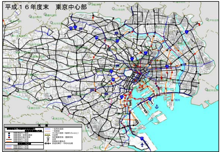
図 18-7 東京都における緊急輸送道路の耐震補強マップ (平成 16 年度末)
