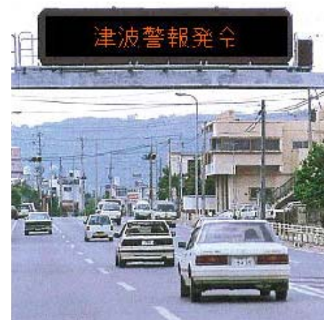
写真. 道路情報板による情報提供 (仙台河川国道事務所での取り組み。 写真は、津波警報発令状況イメージ)
