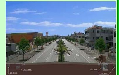
図 電線類地中化
