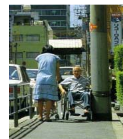
車いすの通行を妨げる電柱
